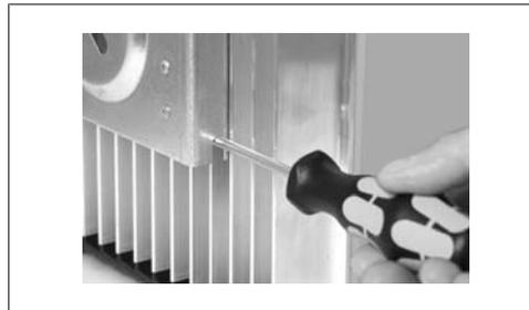
Abbildung 8.9: Demontageverfahren für Wechselrichter
